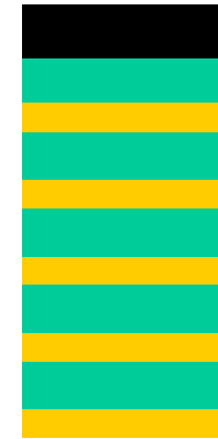
5 x [Ti( 4nm)/Mg( 8nm)]
